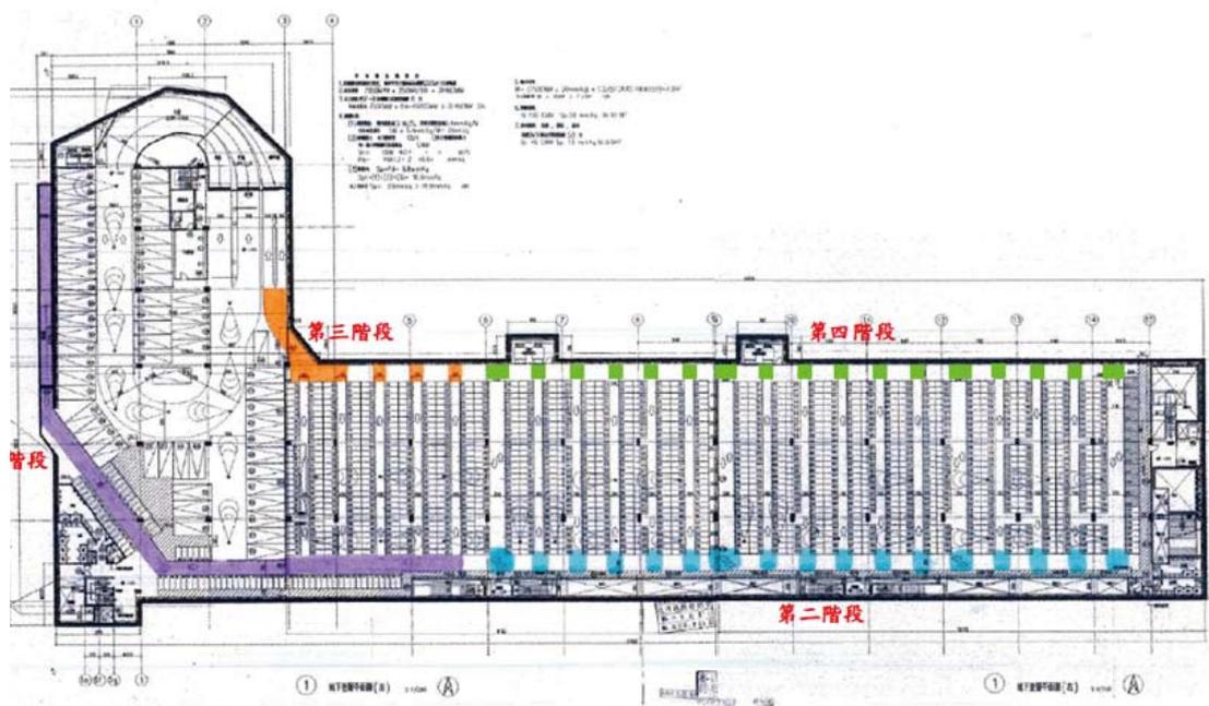
新南地下機車停車場分階段施作止滑塗層示意圖
