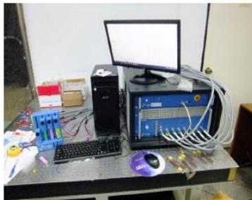
模組式電池充放電設備
