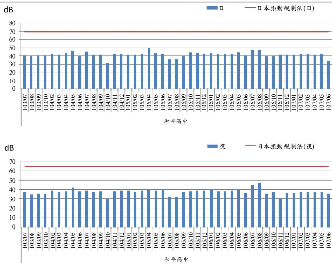
圖2.3-12 振動歷次監測結果趨勢圖—和平高中
