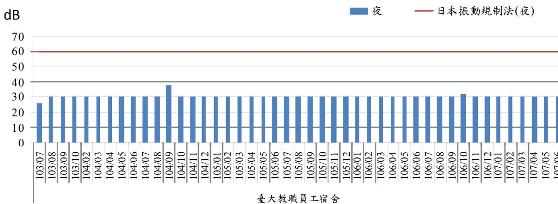
圖2.3-9 振動歷次監測結果趨勢圖－臺大教職員工宿舍
