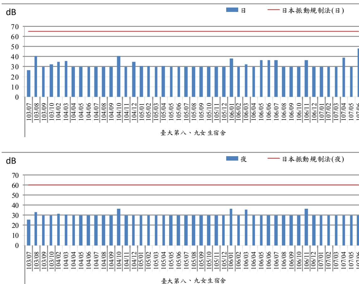
圖2.3-8 振動歷次監測結果趨勢圖－臺大第八九女生宿舍
