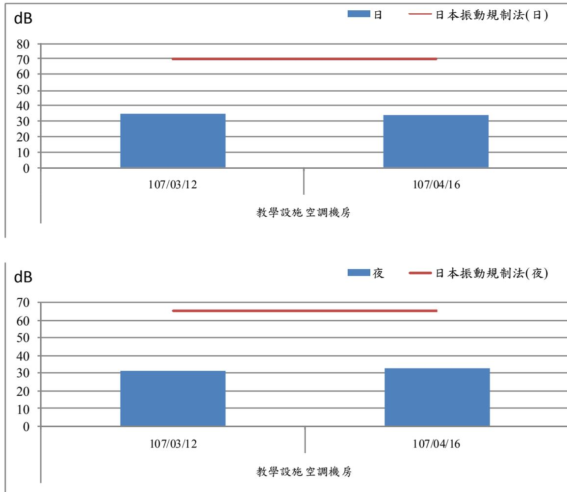
圖2.3-13 振動歷次監測結果趨勢圖－教學設施空調機房
