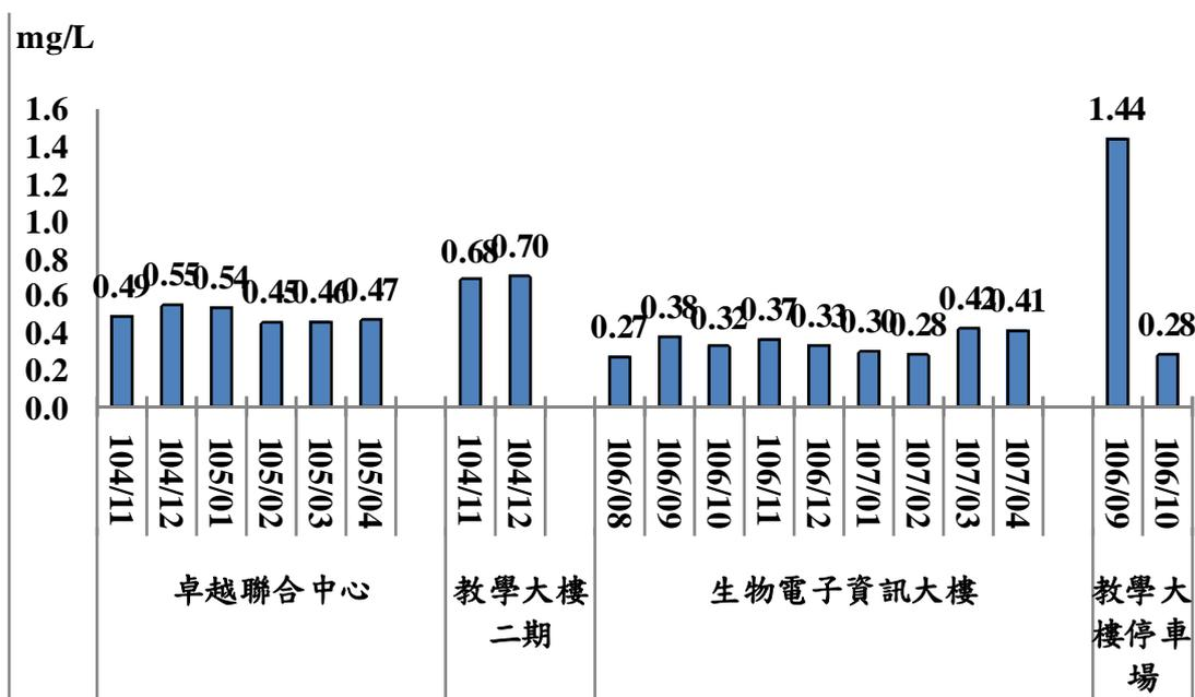
圖2.2-4 放流水水質氨氮歷次監測結果趨勢圖
