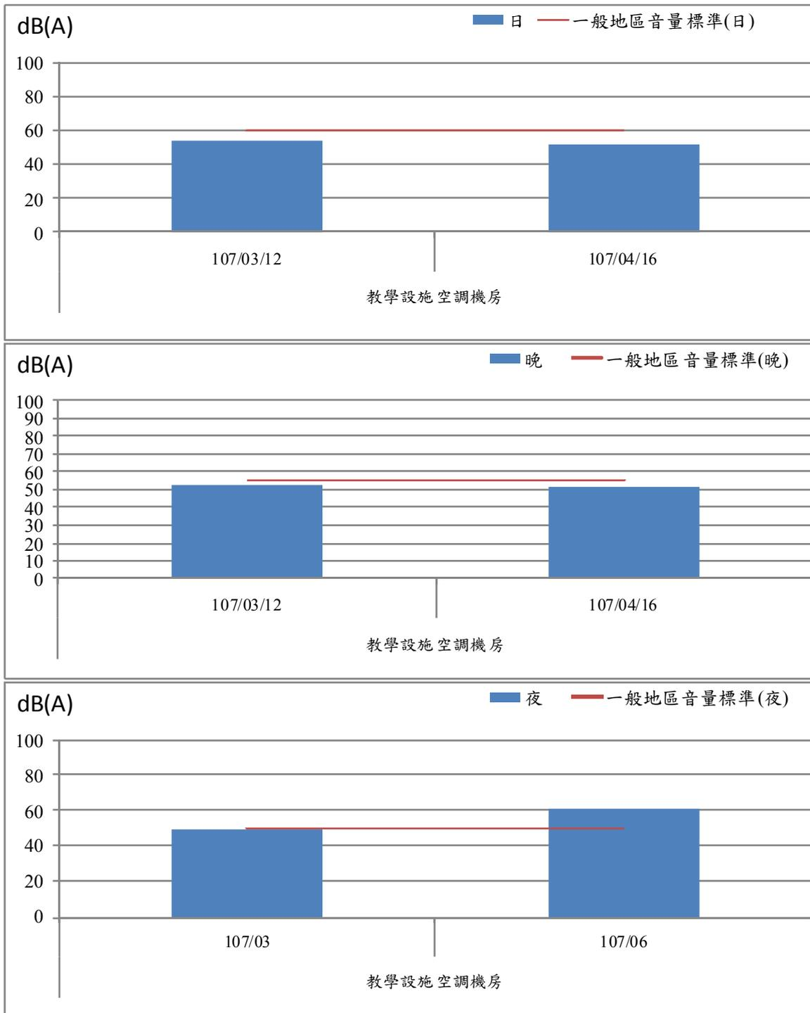
圖2.3-7 噪音歷次監測結果趨勢圖－教學設施空調機房
