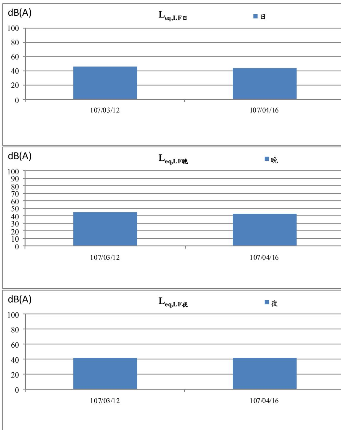
圖2.3-8 噪音歷次監測結果趨勢圖( $L_{eq,LF}$ )—教學設施空調機房
